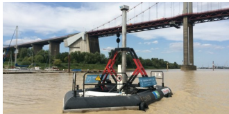
Exemple d'installation d'une hydrolienne dans un fleuve unidirectionnel
